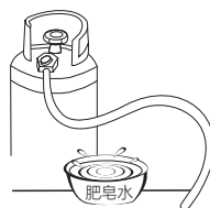
管道气密性检测
